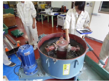
写真 1:コンクリート製作実習
