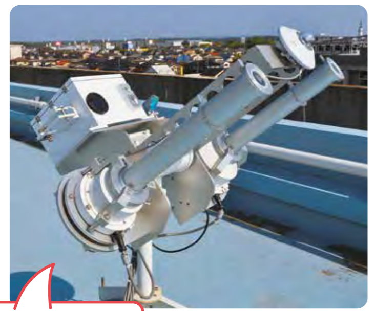
太陽を自動追尾して太陽電池の効率アップ!
