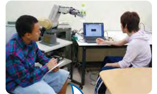
筋電信号を用いて、ロボットアームの操作を試みています
