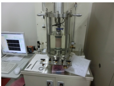
写真3 万能振動三軸試験
