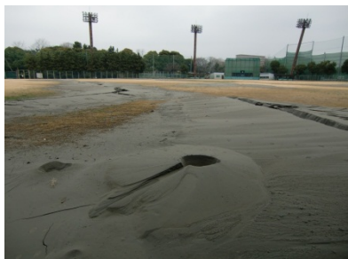
写真1 液状化した噴砂の痕跡 (浦安市中央公園)
