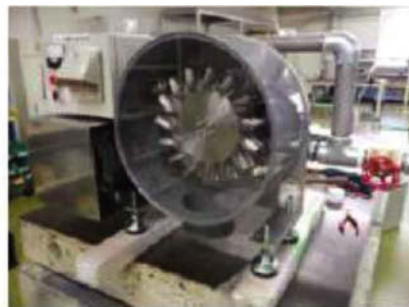
写真1 開発したペルトン式小水力発電装置
