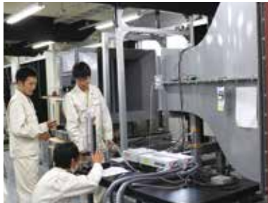
三次元風洞を用いた円柱まわりの静圧測定
