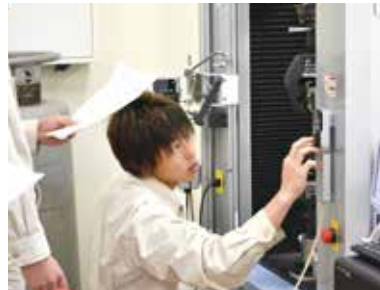
引張試験機で厚さ5ミリの鋼板を引きちぎる
