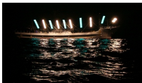
国際化工・千葉県水産総合研究センターとの共同で開発したサンマ漁船用 LED 集魚灯
