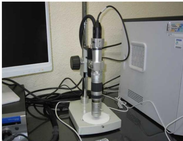
**主な仕様及び特長:** 拡大画像の観察と3D画像の構築が可能なデジタルマイクロスコープです。観察画像はJPEG形式で保存できます。レンズは20～160倍(15型モニター倍率)のズーム機能を備えており、観察物に最適な光照射が得られる可変照明アダプタを搭載しています。
