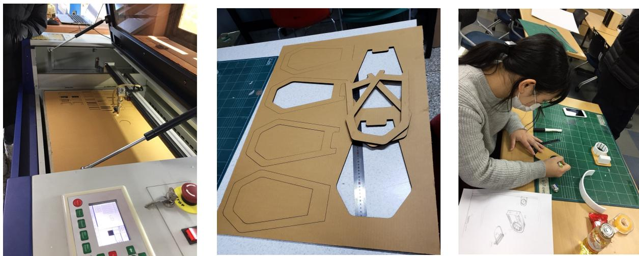
図6 レーザーカッターと段ボール板によるプロトタイピング
