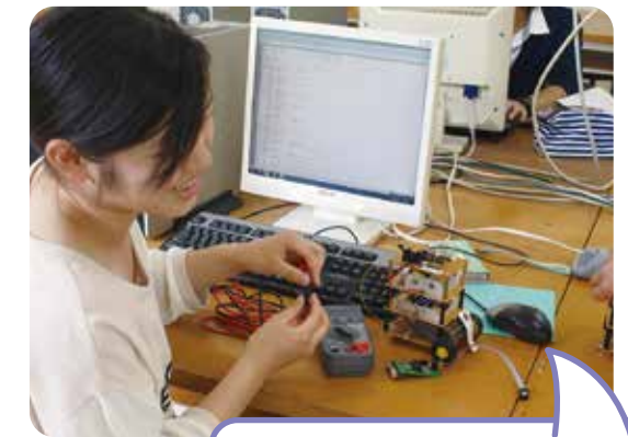
1年次に製作したライトレーサにマイコンを搭載して制御(4年生)
