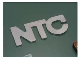
機械工場に新しく導入されたCO<sub>2</sub>レーザー加工機は、鋼材やアルミなどの金属をはじめとし、アクリル、や木材などの材料を自由かつスピーディに切断加工することができる機械です。1200×1200mmまでの材料を切断加工することが可能です。
