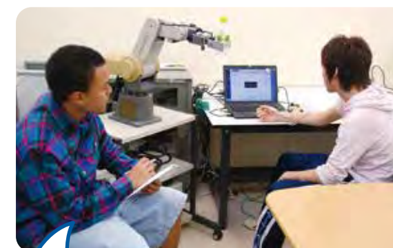
筋電信号を用いて、ロボットアームの 操作を試みています
