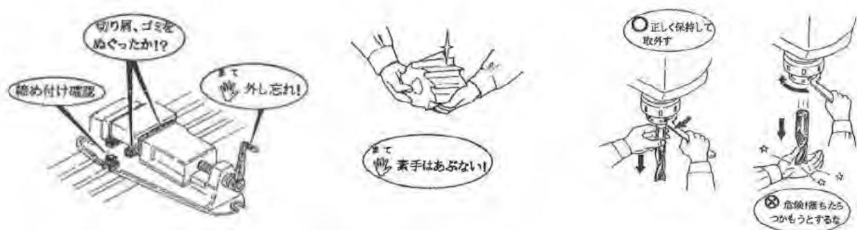
図 1 3 工作物・固定具、切削工具の取り付け・取り外し
