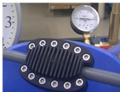
図 2 0.5 MPa(左)と 1.75 MPa 超(右)での 1 分間の止水成功
