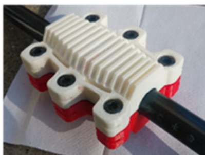
図 2 0.5 MPa(左)と 1.75 MPa 超(右)での 1 分間の止水成功
