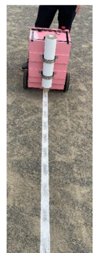
図 3 IMU を用いた進行方向制御による直線描画
